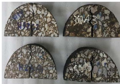
شکل ۲۱. مسیر رشد ترک آزمایشگاهی در نمونه‌های SCB تحت مود اول شکست
