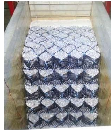
شکل ۴. تصویر و نمای شماتیک چیدمان ژئوسل در مدلسازی فیزیکی دیوار حائل (Latha and Manju, 2016)
