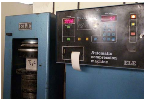
شکل ۳. آزمایش مقاومت فشاری
