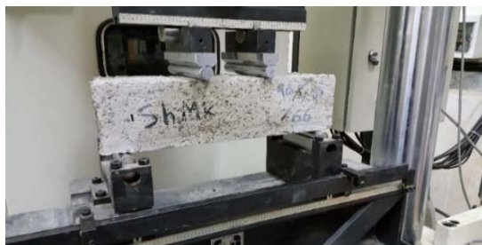
شکل ۶. دستگاه UTM جهت بارگذاری خمشی
