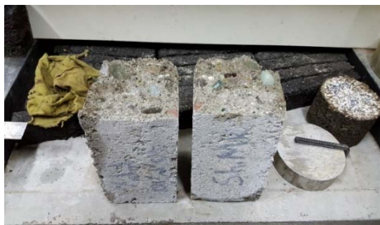
شکل ۷. نمونه بتن غلتکی پس از بارگذاری خمشی
