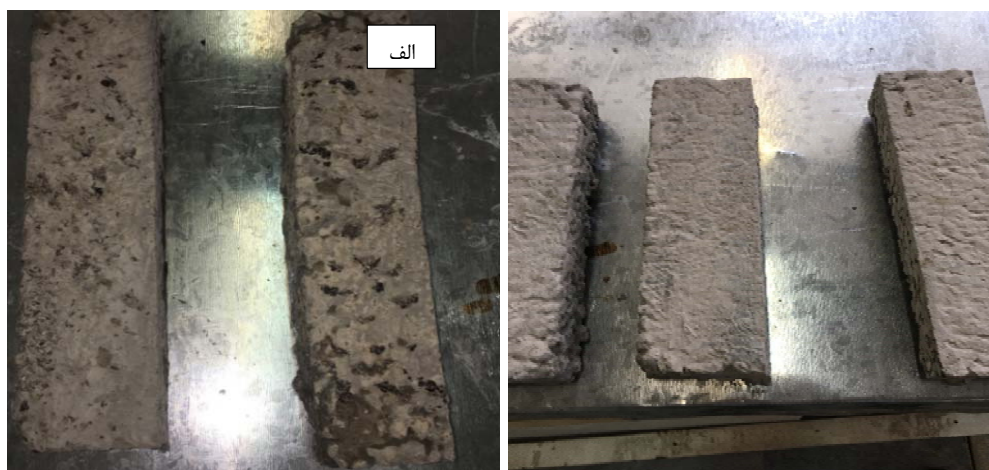
شکل ۱۰. نمونه‌های بتن غلتکی برای آزمایش دوام (الف: قبل و ب: بعد از آزمایش)
