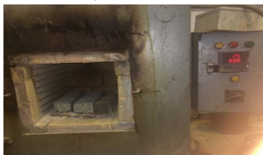
شکل ۴. روش انجام آزمایش آتش‌سوزی
