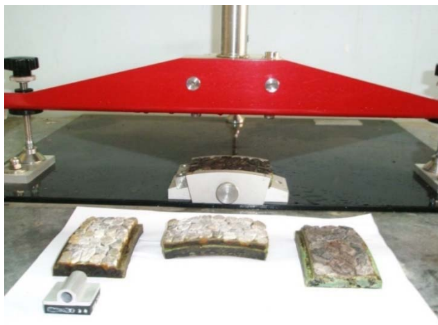
شکل ۶. انجام آزمایش لغزندگی بر روی نمونه‌های رزینی
