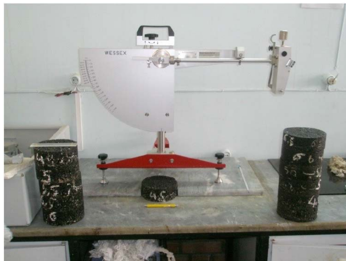
شکل ۴. انجام آزمایش مقاومت لغزندگی با دستگاه آونگ انگلیسی بر روی نمونه‌های آسفالتی
