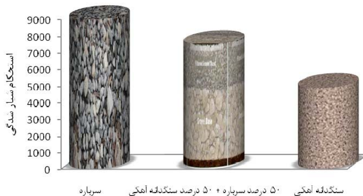
شکل ۳. نتایج آزمایش خزش دینامیکی با دستگاه UTM (برحسب تعداد سیکل بارگذاری تا لحظه رسیدن به ناحیه تسلیم)
