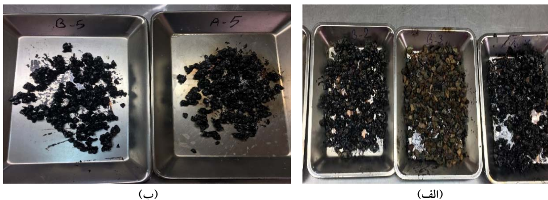
شکل ۲. پوشش مصالح سنگی با قیر امولسیون بدون لاتکس (الف) و پوشش مصالح سنگی با قیر امولسیون با افزودن لاتکس (ب)
