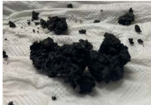
شکل ۷. آزمایش عریان شدگی در آب جوشان و نمونه مورد آزمون قرار گرفته
