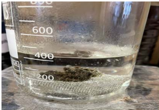
شکل ۷. آزمایش عریان شدگی در آب جوشان و نمونه مورد آزمون قرار گرفته
