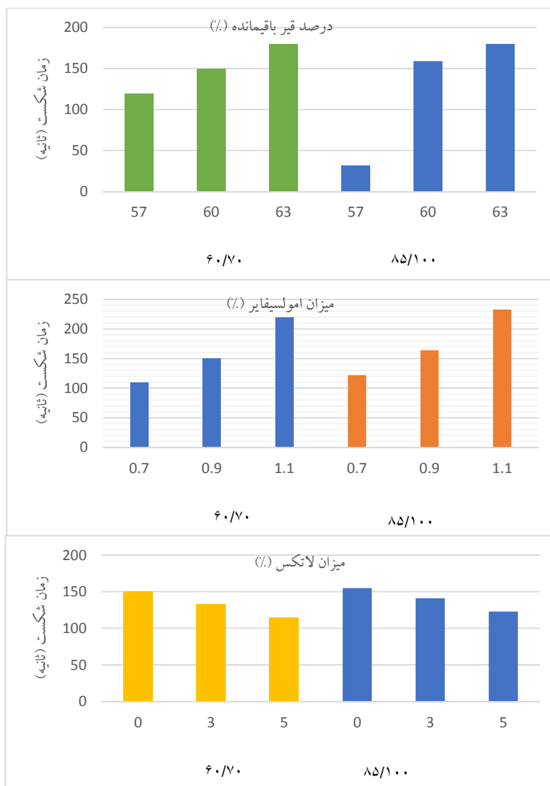
نمودار ۲. بررسی اثر میزان امولسیفایر، درصد قیر باقیمانده و میزان لاتکس بر زمان شکست قیر امولسیون در زمان اختلاط با مصالح سنگی
