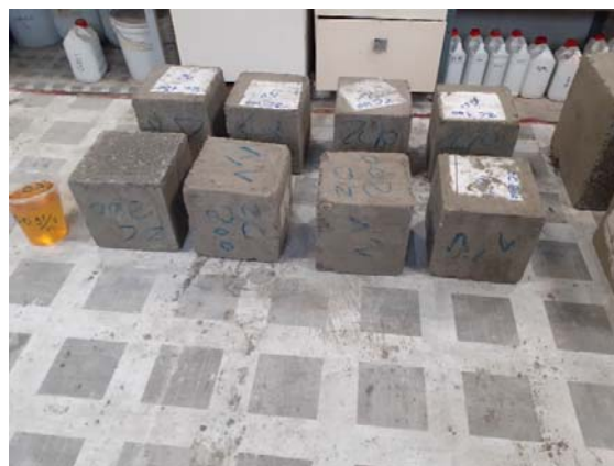
شکل ۵. آزمون‌های مکعبی جهت ارزیابی جذب آب بتن مطابق با استاندارد BS-1881-122
