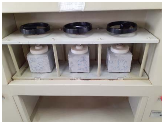
شکل ۶. آزمون‌های مکعبی جهت ارزیابی جذب آب بتن مطابق با استاندارد BS EN 12390-8
