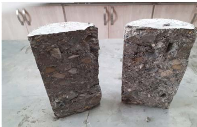
شکل ۳. ارزیابی مقاومت کششی دو نیم شدن مخلوط‌های بتنی مطابق با استاندارد ASTM C496
