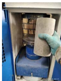
شکل ۲. ارزیابی مقاومت فشاری مخلوط‌های بتنی مطابق با استاندارد ASTM C39
