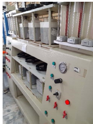
شکل ۶. آزمون‌های مکعبی جهت ارزیابی جذب آب بتن مطابق با استاندارد BS EN 12390-8
