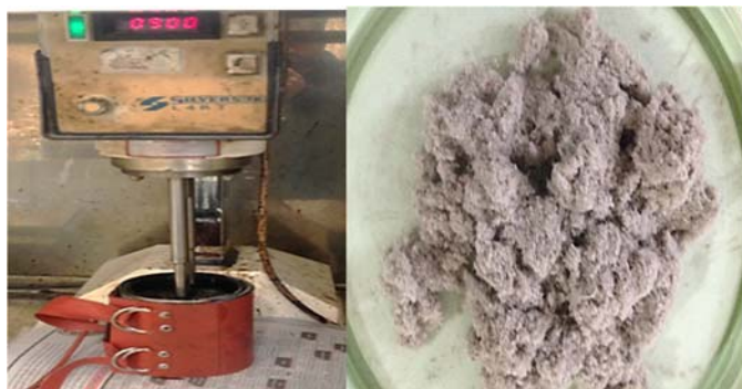
شکل ۲. تصویر الیاف پودر شده آماده برای اضافه شدن به قیر پودرلاستیکی در ۹۰۰ دور دقیقه
