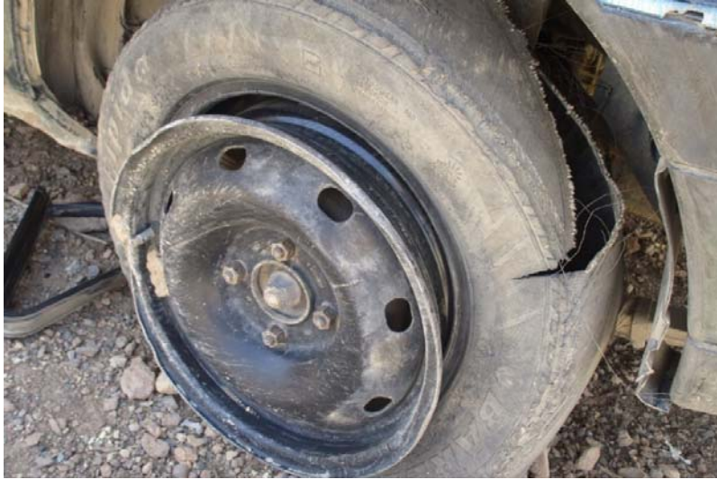
شکل ۵. ترکیدگی لاستیک، محور داران، تیران
