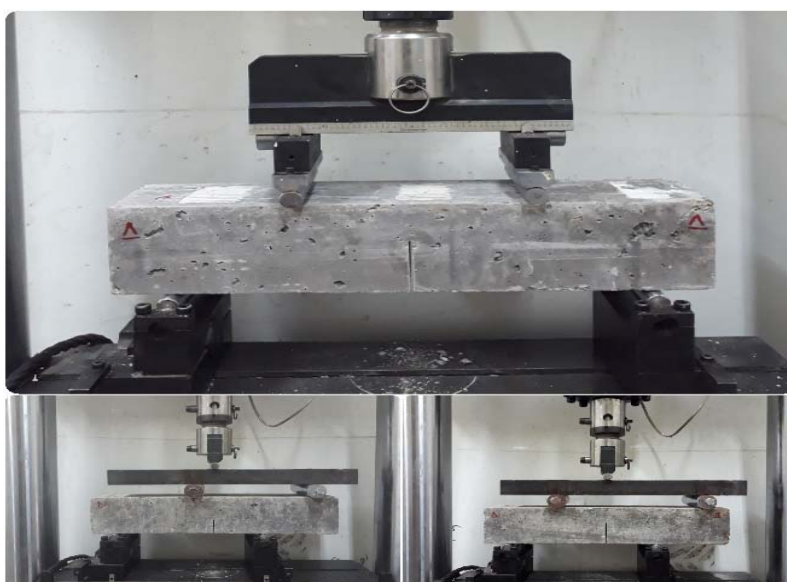
شکل ۶. نمونه تیر خمشی شیاردار تحت آزمایش شکست در وضعیت‌های بارگذاری به ترتیب بالا متقارن، سمت راست پایین پادمقارن و پایین سمت چپ ترکیبی
