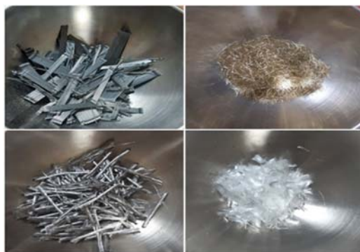
شکل ۵. تصاویر الیاف‌های مورد استفاده به ترتیب از بالا سمت راست: الیاف میکرو فلزی، سمت چپ: ماکرو فلزی و از پایین سمت راست: میکرو سنتتیک، سمت چپ: ماکرو سنتتیک
