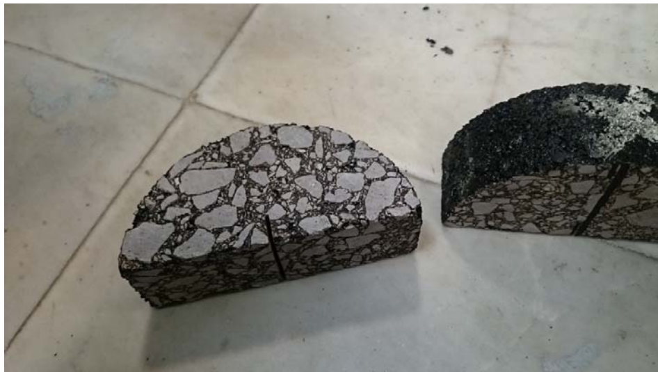
شکل ۳. نمونه‌های بتن آسفالتی مورد استفاده در آزمایش SCB
