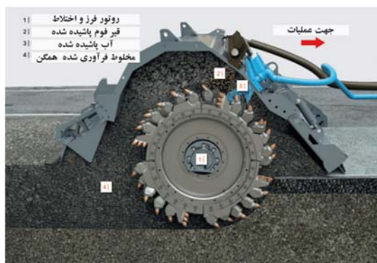
شکل ۱. پردازش مواد در حین بازآفت سرد با دستگاه WR
