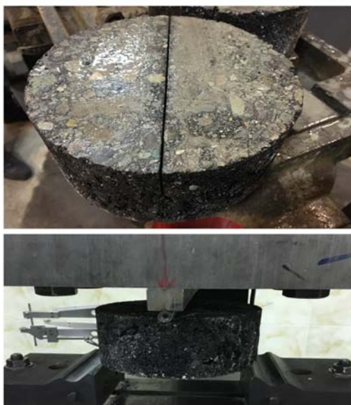
شکل ۱. برش نمونه استوانه‌ای به دیسک‌های با ضخامت ۳ سانتی‌متر و برش نمونه‌های دایره‌ای به نیم‌دایره‌ای
