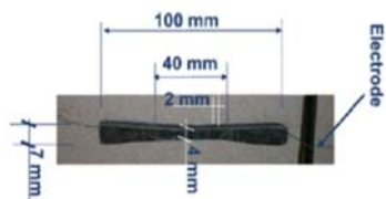
شکل ۹. حسگرهای سیمانی مسلح شده با نانولوله‌های کربنی تک‌لایه‌ای (Saafi 2009)
