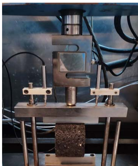
شکل ۳. آزمایش خستگی کشش غیرمستقیم
