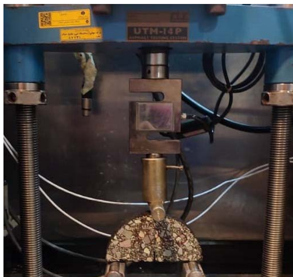
شکل ۲. آزمایش خمش نیم‌دایره
