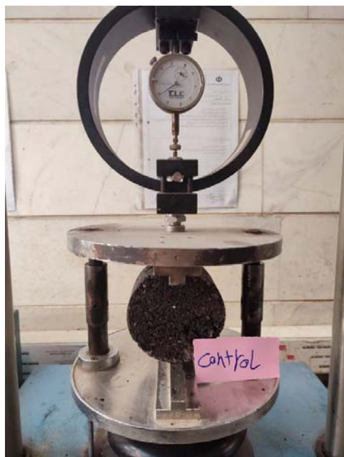
شکل ۴. آزمایش لاتمن اصلاح شده
