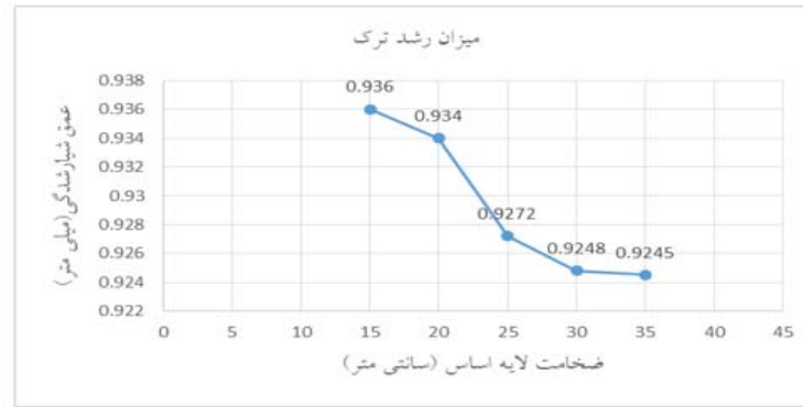
شکل ۱۹. نمودار میزان رشد ترک با فرض تغییر ضخامت لایه اساس و ثابت ماندن ضخامت لایه رویه و زیراساس
