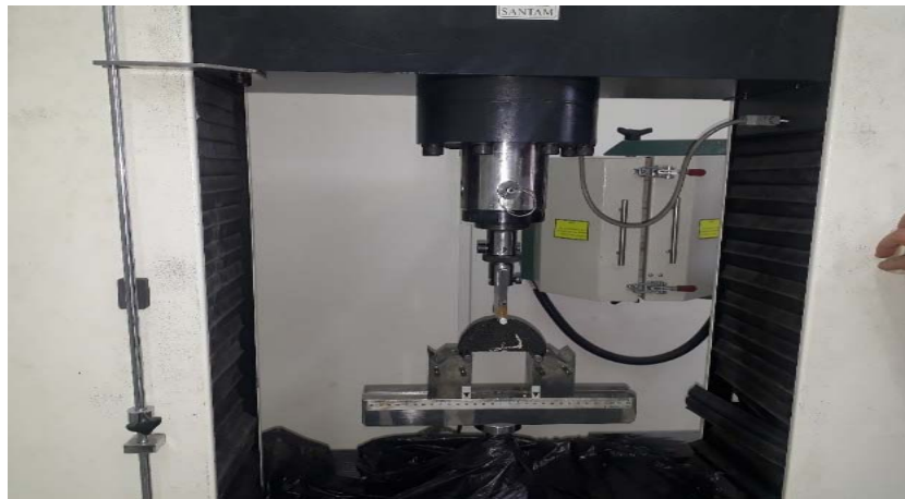
شکل ۴. آزمایش خمش نیم‌دایره
