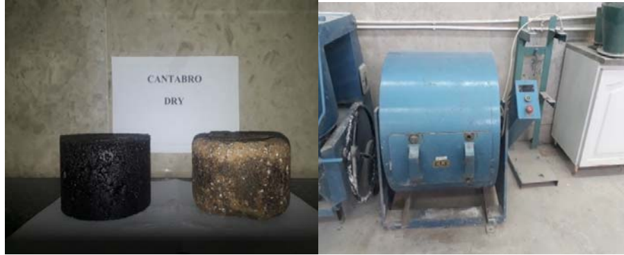
شکل ۳. دستگاه لس انجلس و نمونه‌ها قبل و پس از انجام آزمایش کانتابرو
