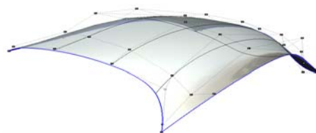
شکل ۲. شبکه نقاط کنترلی و سطح نریز مربوط به آن
