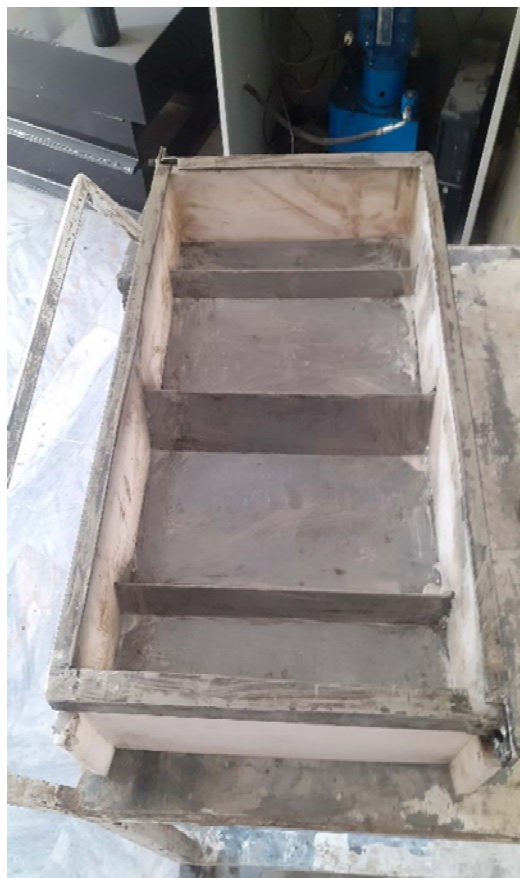
شکل ۳. قالب و ابزار فولادی مورد استفاده در تحقیق مطابق با استاندارد ASTM C1579
