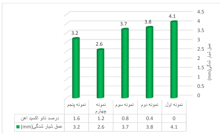
شکل ۹. عمق شیار نمونه‌ها بر حسب درصد نانو اکسید آهن در دمای ۵۰ درجه سانتی‌گراد
