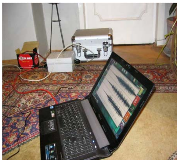
شکل ۴. اندازه گیری ارتعاش داخل ساختمان حین عبور قطار
