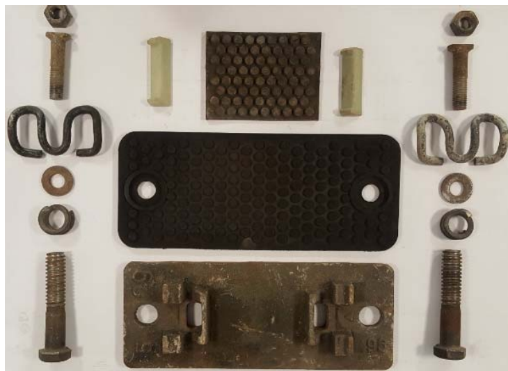
شکل ۱. قطعات نمونه پابند تیپ چینی مورد استفاده در اکثر مقاطع خطوط مترو تهران
