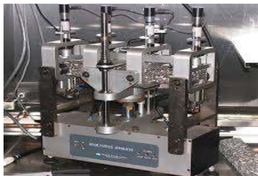
شکل ۴. نمای از دستگاه Beam Fatigue
