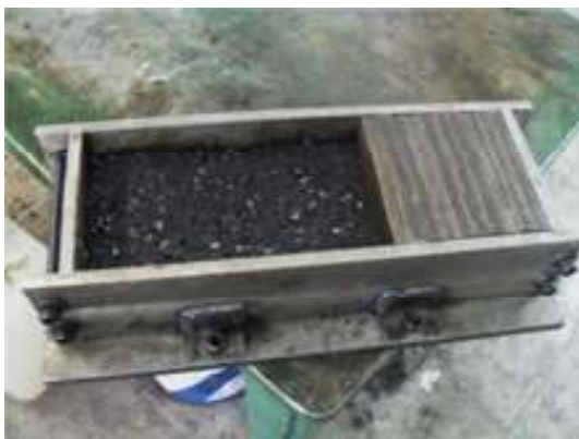
شکل ۱. نمایی از نحوه ساخت و تراکم دال
