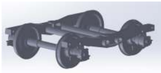
شکل ۴. بوژی واگن متروی تهران در حالت مونتاژ شده
