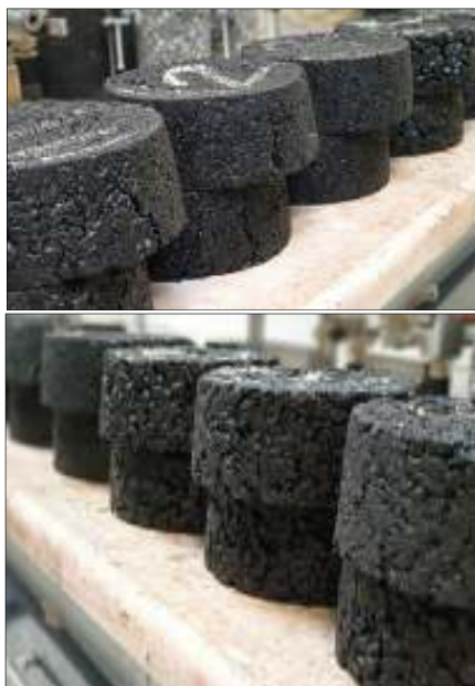
شکل ۱۳. نمونه‌های آزمایش خزش دینامیکی پس از پایان بارگذاری
