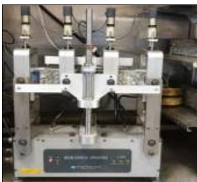
شکل ۵. دستگاه آزمایش خستگی تیرچه خمشی چهار نقطه‌ای
