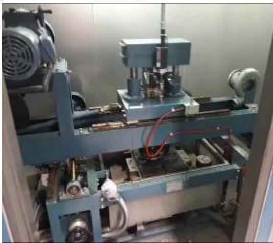
شکل ۳. دستگاه چرخ بارگذاری و واحد کنترل آن
