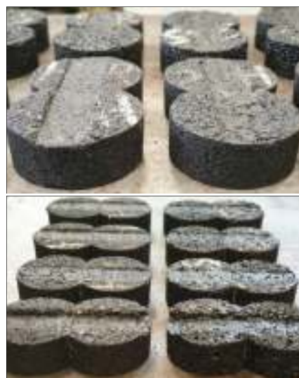
شکل ۱۰. نمونه‌های آزمایش شیارافتادگی پس از اتمام آزمایش
