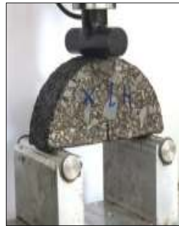
شکل ۷. قاب بارگذاری و نمونه آزمایش شاخص انعطاف‌پذیری
