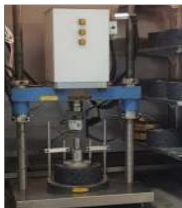
شکل ۴. دستگاه UTM و قاب بارگذاری آزمایش خزش دینامیکی
