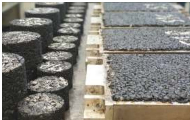
شکل ۱. انواع نمونه‌های آسفالتی مترکم مورد آزمایش
