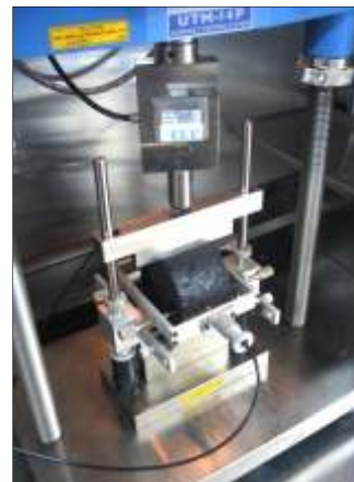
شکل ۲. قاب بارگذاری و ابزار آزمایش مدول برجهندگی
