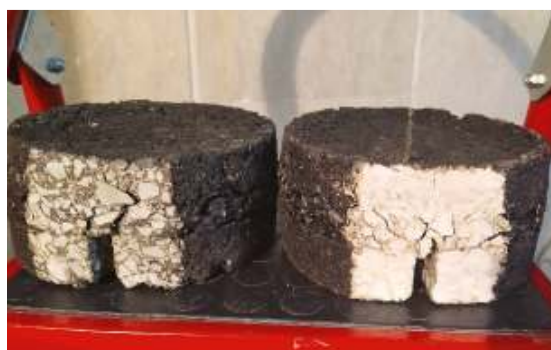
شکل ۹. نمونه‌های آسفالتی پس از آزمایش خزش دینامیکی
