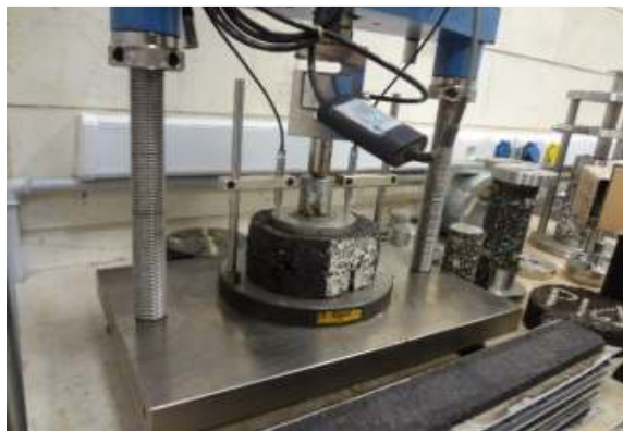
شکل ۸. نمایی از آزمایش خزش دینامیکی
