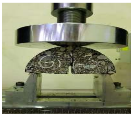
شکل ۴. نحوه قرارگیری نمونه در زیر دستگاه یونیورسال
