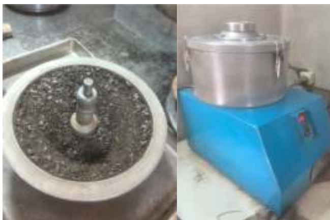
شکل ۴. جداسازی و تعیین مقدار قیر خرد آسفالت با استفاده از دستگاه سانتریفیوژ
