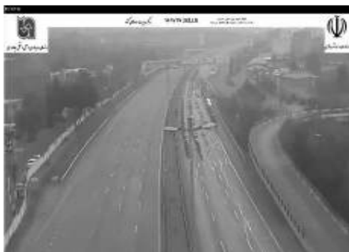
شکل ۳. استخراج تصویر پس‌زمینه با استفاده از مُد در ترافیک سبک (جاده سمت چپ) و سنگین (جاده سمت راست)
