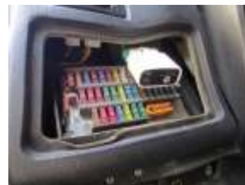
شکل ۳. اتصال دیاگ بلوتوثی مصرف سوخت به خودرو
