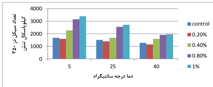
شکل ۵. تعداد سیکل برای شکست نسبت به دما برای درصد‌های مختلف افزودنی در ۳۵۰ پاسکال
