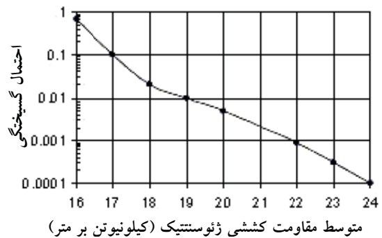
شکل ۹. احتمال گسیختگی در مقابل متوسط مقاومت کششی ژئوستتیک
