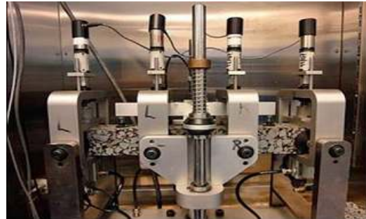
شکل ۷. تنظیمات و طرح آزمایش تیر خمشی چهار نقطه‌ای
