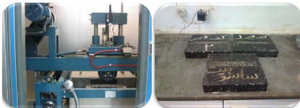
شکل ۱۸. نمونه ای از دال آسفالتی آزمایش شیارشدگی و دستگاه آزمایش
