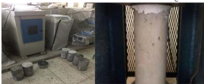
شکل ۴. نمونه و دستگاه اندازه‌گیری مقاومت فشاری
