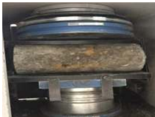
شکل ۶. نمونه و دستگاه اندازه‌گیری مقاومت کششی غیرمستقیم
