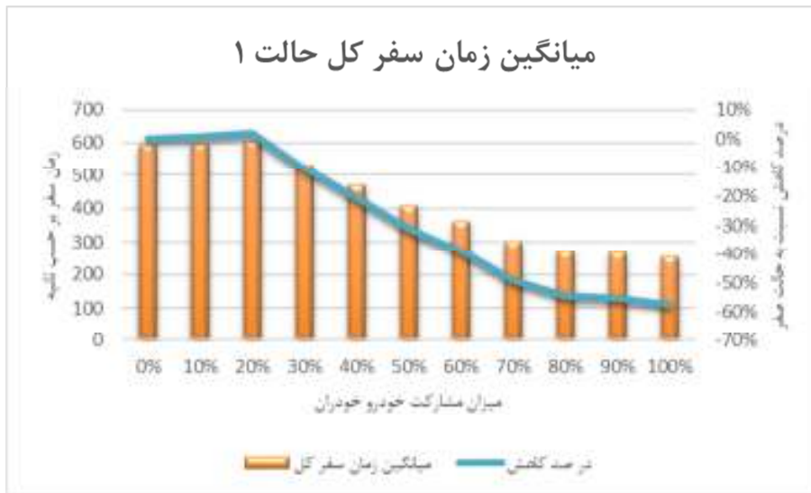
شکل ۹. نمودار میانگین زمان سفر نسبت به مشارکت خودرو خودران در حالت اشباع
