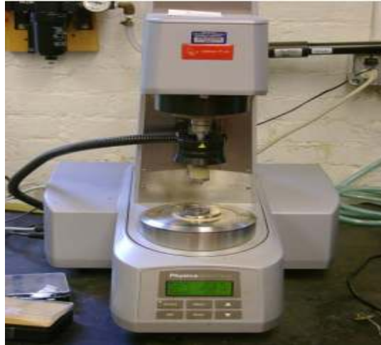
شکل ۲. دستگاه رئومتر برش دینامیکی
