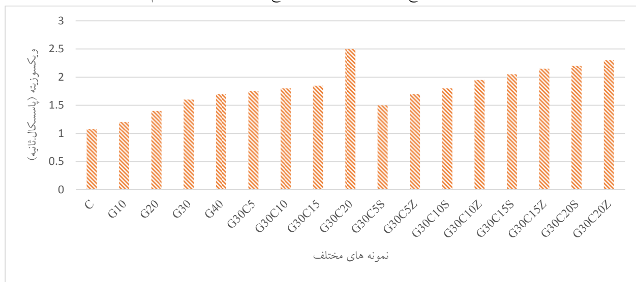
شکل ۵. نتایج آزمایش ویسکوزیته قیر
