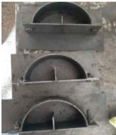
شکل ۲. قالب‌های مربوط به تهیه نمونه‌های نیم‌دیسکی با عمق شکاف مختلف
