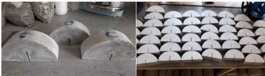
شکل ۳. نمایی از نمونه‌های تهیه شده برای آزمایش مقاومت شکست
