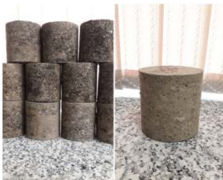
شکل ۴. یک نمونه تکی در کنار تعدادی از نمونه‌های عمل‌آوری شده
