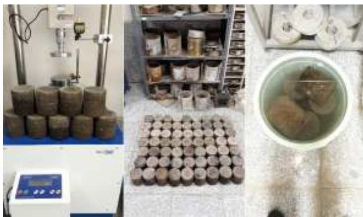
شکل ۵. نمونه‌ها در وضعیت قبل و پس از غرقاب ۴ ساعته
