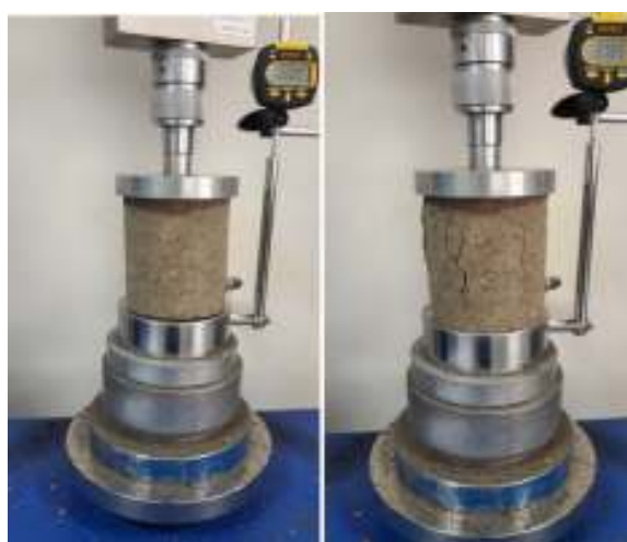
شکل ۶. نمونه قبل و پس از گسیختگی در آزمایش فشاری تک محوری
