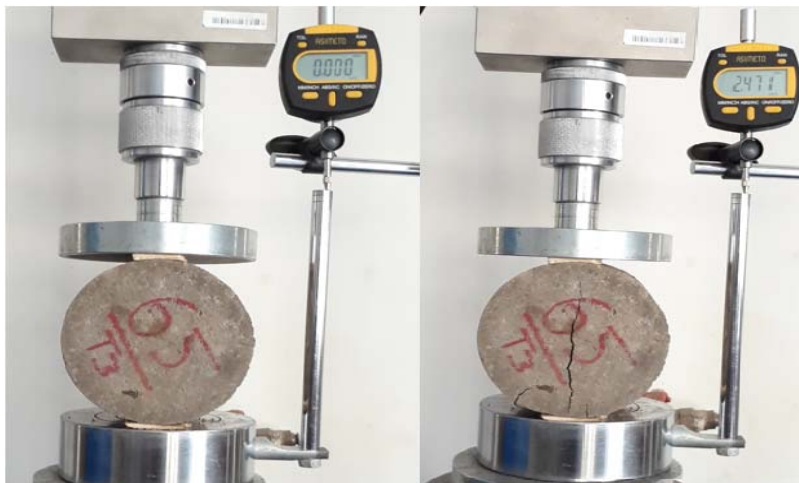
شکل ۲۱. نمونه قیل و پس از بارگذاری در آزمایش کششی غیر مستقیم
