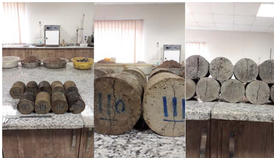
شکل ۲۲. نمونه‌های گسیخته شده در آزمایش کششی غیرمستقیم
