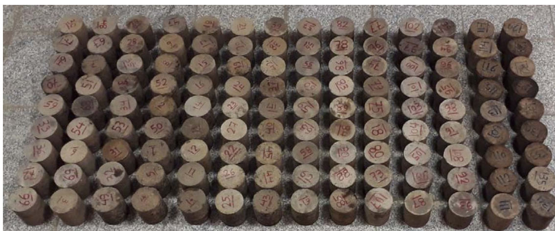
شکل ۴. تعدادی از نمونه‌های CTB ساخته شده از مخلوط ۱۰۰ درصد RAP تثبیت شده با سیمان
