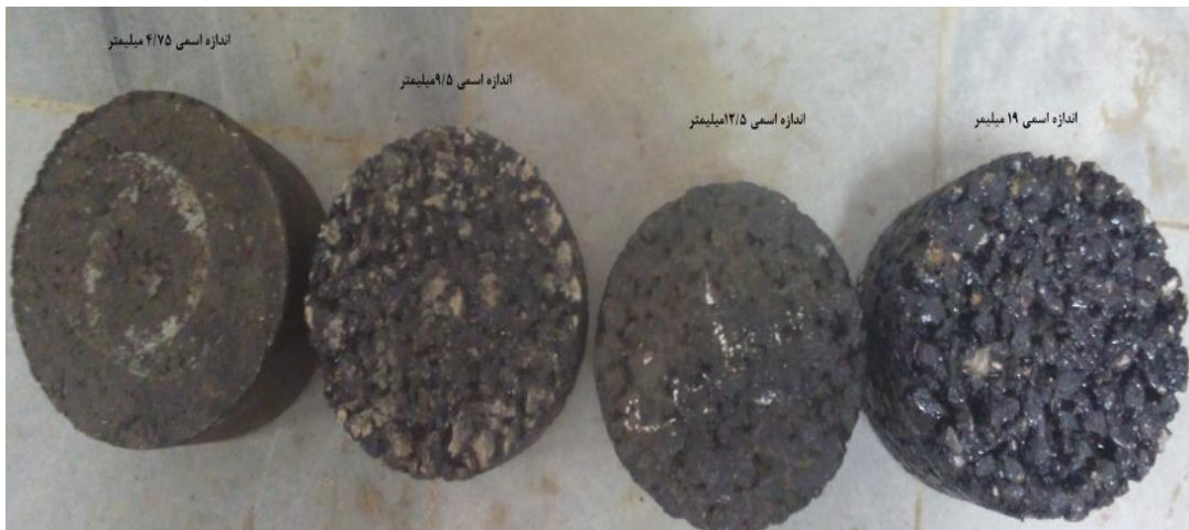
شکل 4. نمونه 15 سانتیمتری ساخته شده و نمایش تاثیر اندازه اسمی بر شکل ظاهری نمونه‌ها
