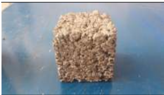
شکل ۳. نمونه مکعبی جهت انجام تست مقاومت فشاری
