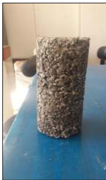
شکل ۶. نمونه استوانه ای جهت انجام تست مقاومت کششی
