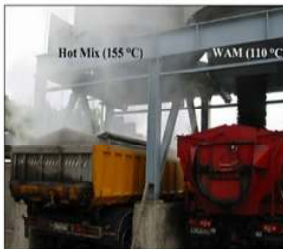
شکل ۲. محدوده درجه حرارت تولید انواع مختلف مخلوط‌های آسفالتی
