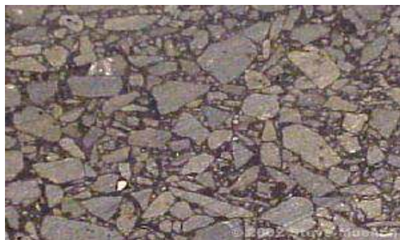
شکل ۱. نمائی از بافت زیر و باز سطح یک روسازی SMA
