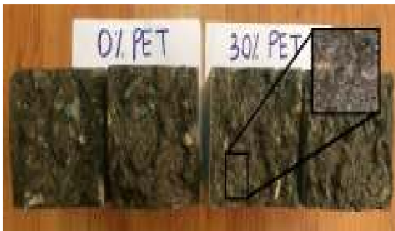
شکل ۱۱. نمونه‌های شکسته شده پس از انجام آزمایش مقاومت خمشی
