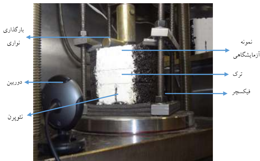
شکل ۵. نمایی از آزمایش بررسی رشد ترک انعکاسی
