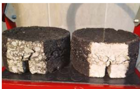
شکل ۹. نمونه‌های آسفالتی پس از آزمایش خزش دینامیکی
