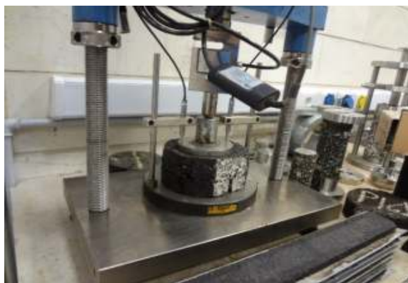
شکل ۸. نمایی از آزمایش خزش دینامیکی
