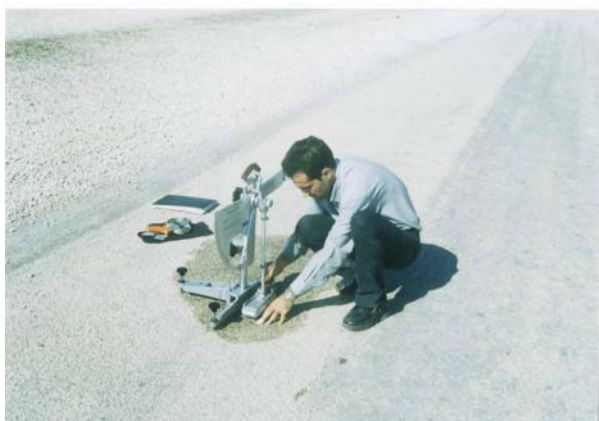
شکل ۲. نحوه تعیین عدد مقاومت در برابر لغزندگی
