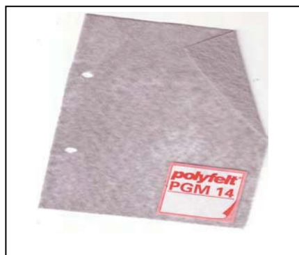
شکل ۱. ژئوتکستایل مورد استفاده در این تحقیق
