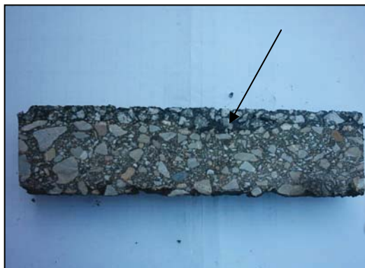
شکل ۲. میزان نفوذ سنگدانه‌های گرانیتی B
