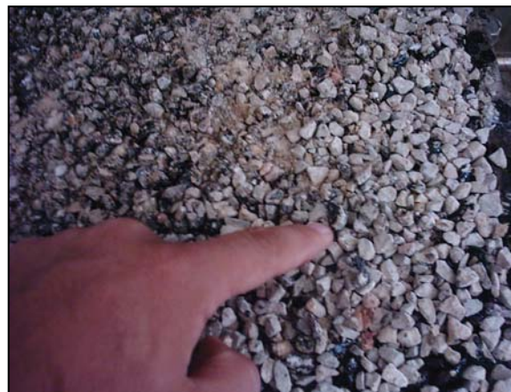
شکل ۱. اثر بار اضافی و خردشدگی سنگدانه‌ها، همچنین اثر میزان سنگدانه اضافی
