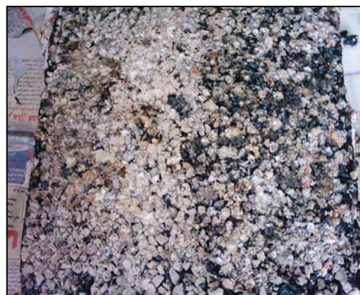
شکل ۵. بافت و مقطع اندود سنگدانه ای آهکی
