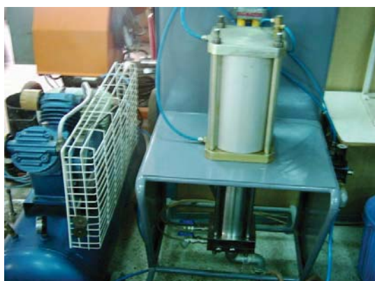
شکل ۴. تجهیزات آزمایش تعیین ضریب نفوذپذیری بتن
