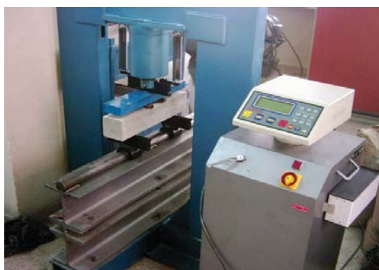
شکل ۳. نحوه قرار گرفتن نمونه خمشی زیر دستگاه
