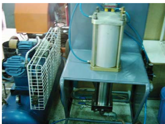
شکل ۴. تجهیزات آزمایش تعیین ضریب نفوذپذیری بتن
