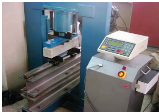
شکل ۳. نحوه قرار گرفتن نمونه خمشی زیر دستگاه
