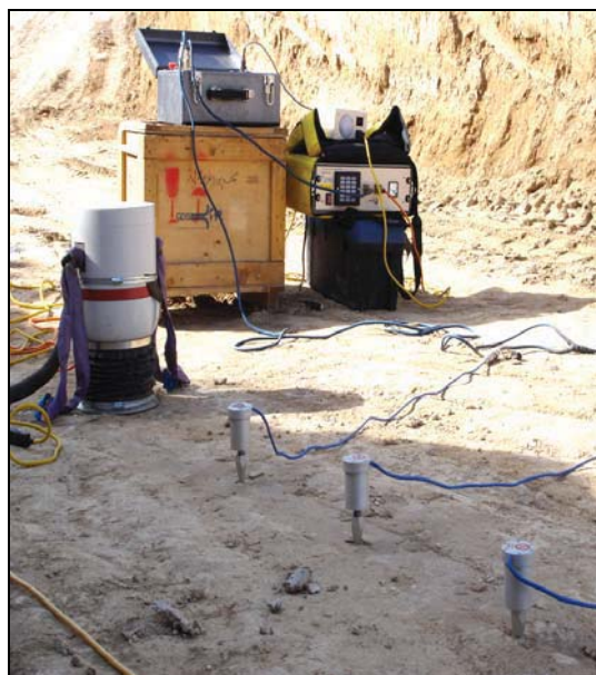
شکل ۴. تجهیزات آزمایش امواج سطحی در محل آزمایش
