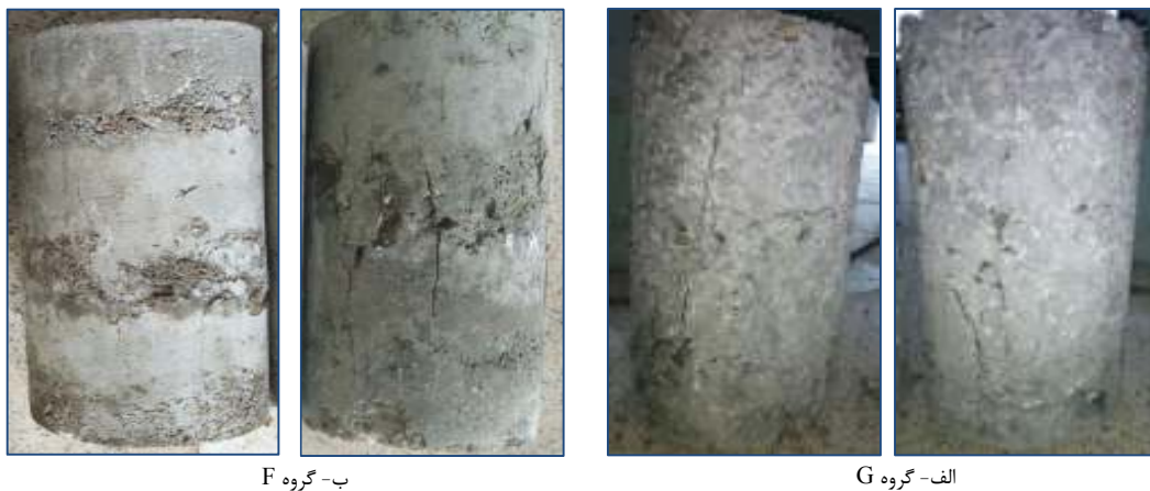
شکل ۳. نحوه‌ی شکست و ایجاد ترک در نمونه‌های استوانه‌ای
