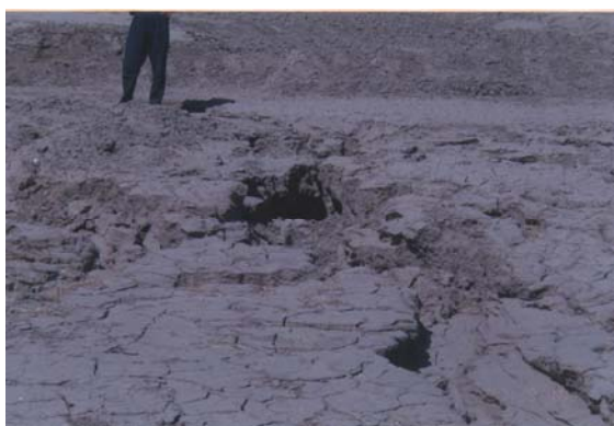
شکل ۲. حفره ایجاد شده در منطقه شمس آباد میبد و گسیختگی‌های شعاعی در اطراف حفره
