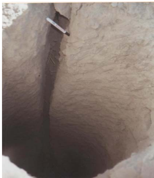
شکل ۶. تصویر شکاف در عمق دو متری در گمانه دستی نزدیک گمانه عمیق
